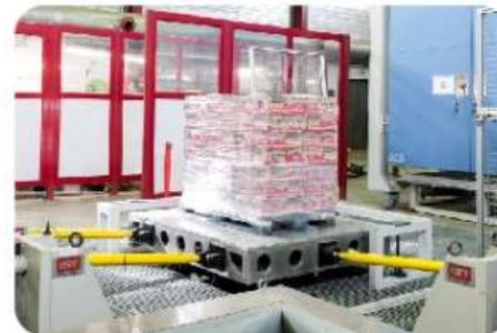
Equipamiento para ensayos de ruido y vibraciones
